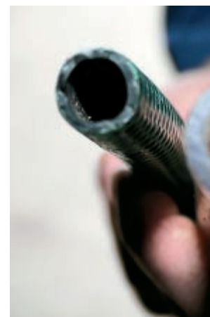
Spröde Schläuche und Ablagerungen von Keimen. Milchführende Gummiteile
