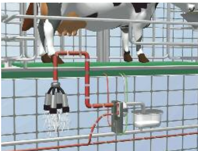
Desinfektionsphase: Beim Backflush-System wird während der Desinfektionsphase die Milchleitung von der Spülleitung getrennt.
